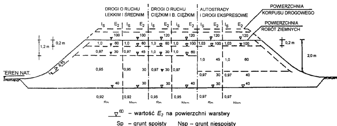
Rysunek 3 - Wartości wymagane w nasypach: wskaźnika zagęszczenia I_s i wtórnego modułu odkształcenia E_2 , megapaskali
